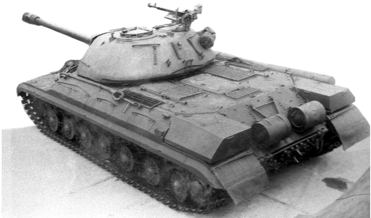
Танк Т-10, вид сзади сверху. Хорошо видны наружные топливные баки, укладка дымовых шашек БДШ-5 и крепление ствола орудия по-походному в положении «пушка назад» (РГАЭ).
