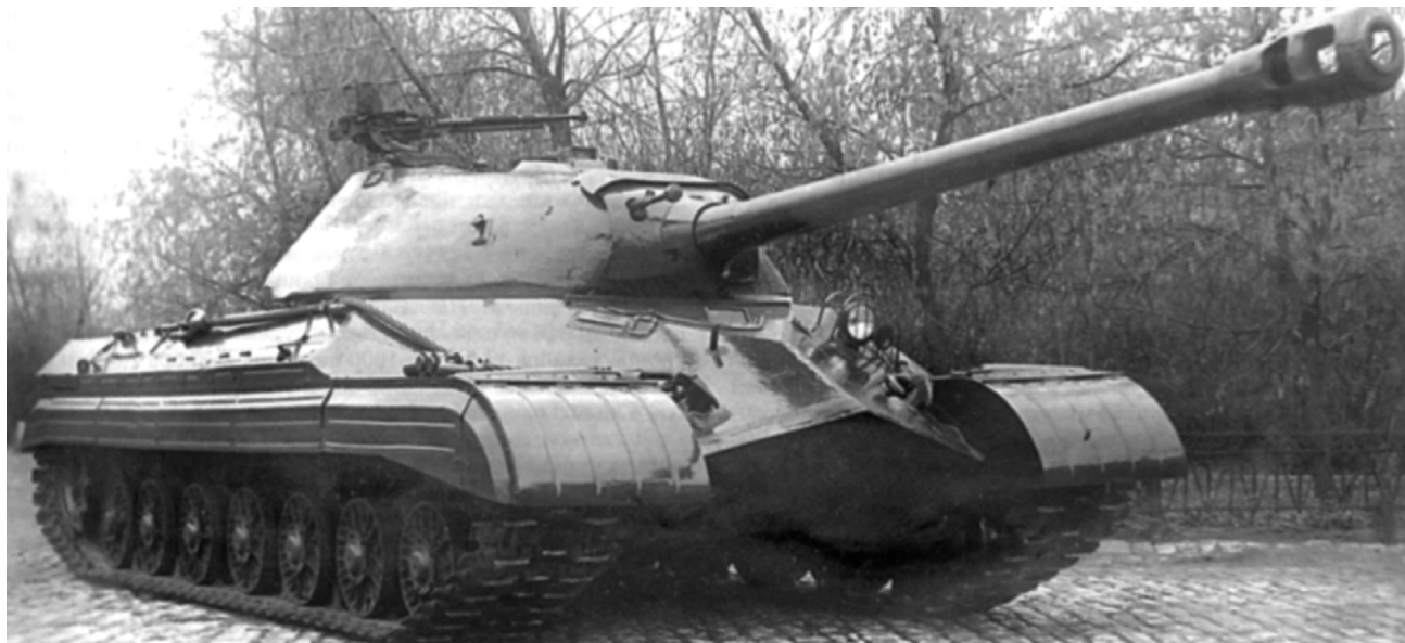
Общий вид опытного танка «объект 730», вид спереди справа. Хорошо видна зенитная установка 12,7-мм пулемета ДШК на башне (РГАЭ).
