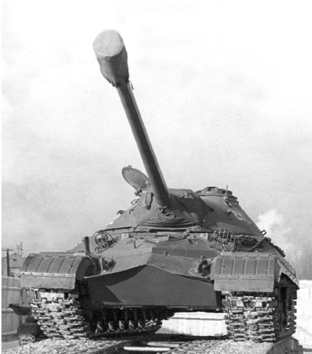
Танк Т-10, общий вид 1955 год. Зенитный пулемет на башне не установлен, на дульный тормоз пушки одет чехол (РГАЭ).
