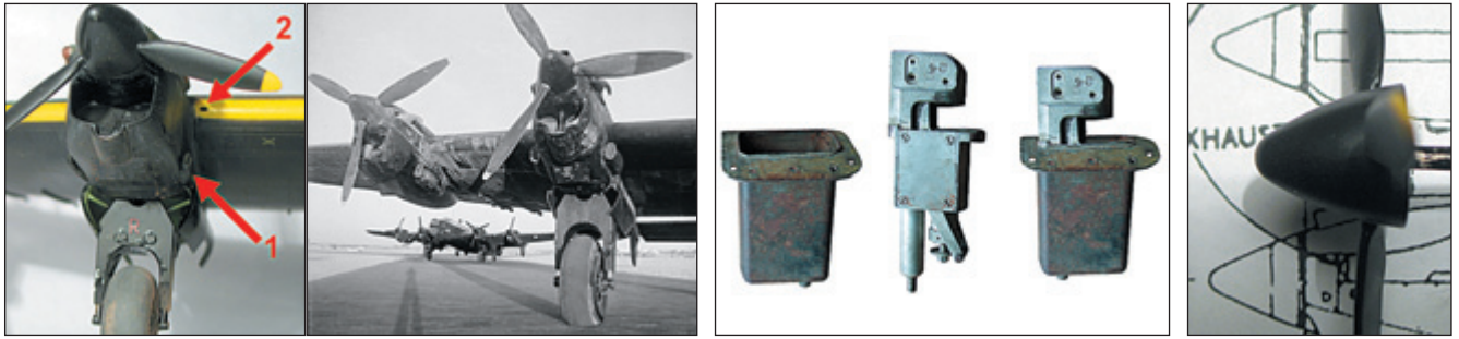
Слева: Мотогондолы на 3 мм шире, чем должны быть, и из-за этого искажена форма воздухозаборника радиаторов. Нет внутренней перегородки, направлявшей воздух в жидкостные и масляный радиатор «Гэллей». Стрелкой 1 указан излишне уплощенный патрубок забора воздуха для нагнетателя карбюратора. 2 – один из портов установки ножей для резания тросов аэростатов заграждения. В центре: Установочный порт и нож для резки тросов аэростатов – справа нож установлен на место. Справа: Кок воздушного винта на 2 мм больше в диаметре, а его форма отнюдь не коническая.
