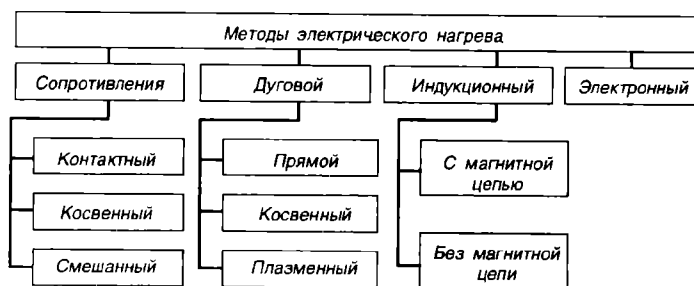
Рис. 2.2. Методы электрического нагрева
