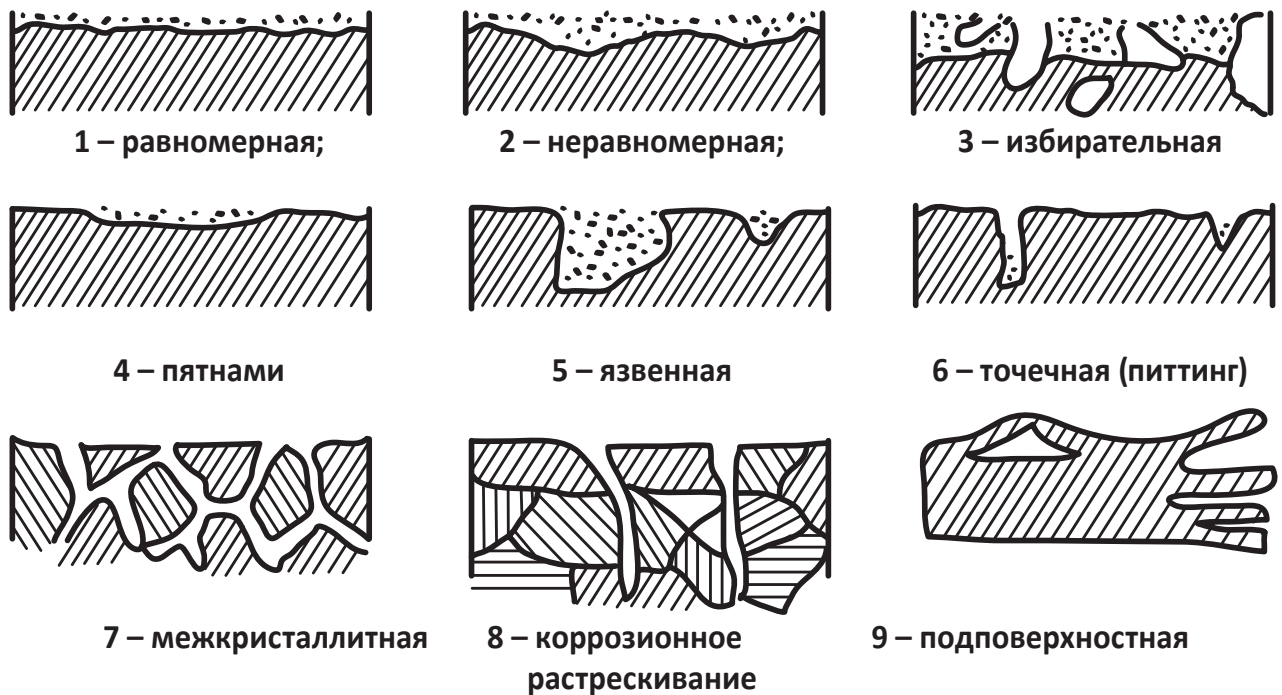
Рис. 2.2. Виды коррозионных разрушений.
