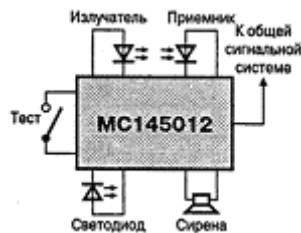
Рис. 1.3. Конструктивная схема включения инфракрасных датчиков – преобразователей сигнала
